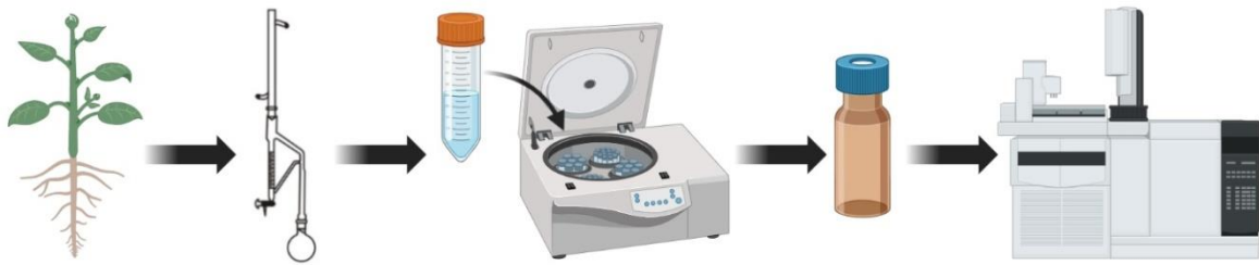
Figura 5 - Obtenção do óleo essencial de A. conyzoides e caracterização por cromatografia gasosa acoplada ao espectrômetro de massas. As folhas do material fresco foram separadas para a retirada do conteúdo inorgânico como terra e pedras. Após 24h em estufa a 37°C foi hidrodestilada em um aparelho de Clevenger modificado. O hidrolato obtido foi então centrifugado para separação da fase oleosa da aquosa. Posteriormente uma alíquota do óleo foi analisada por cromatografia gasosa acoplada ao espectrômetro de massas. Criado com BioRender.com.
